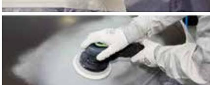
► Exzentrerschleifen mit 3M™ Schleifmitteln 400+ - P500.
