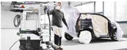
► Verwenden Sie immer eine passende Staubabsaugung und wählen Sie die richtigen Werkzeuge für das Schleifen von Aluminium. Festool Cleantec CTM 48 EC/B22 ist zertifiziert unter der ATEX Richtlinie 94/9/EG für Bereiche der Zone 22.
