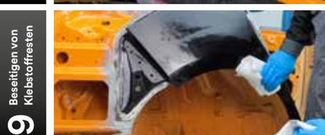
► Entfernen Sie verbliebene Materialreste und Verunreinigungen vom Träger-Fahrzeugblech. Vorbereitung der verbleibenden Gegenflansche am Träger-Fahrzeugblech mit Scotch-Brite™ Schleifband oder Scheibe
